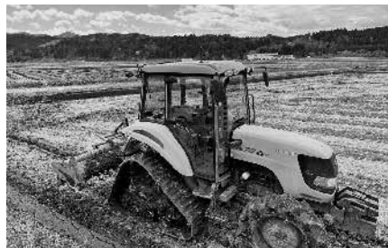
↑トラクター上部に取り付けられた機械が位置情報をキャッチし、自動運転が可能に
