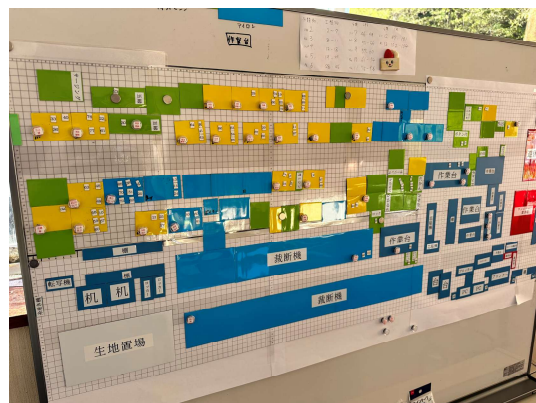
生産変動に応じてレイアウト変更が見える化（マグネット式）
